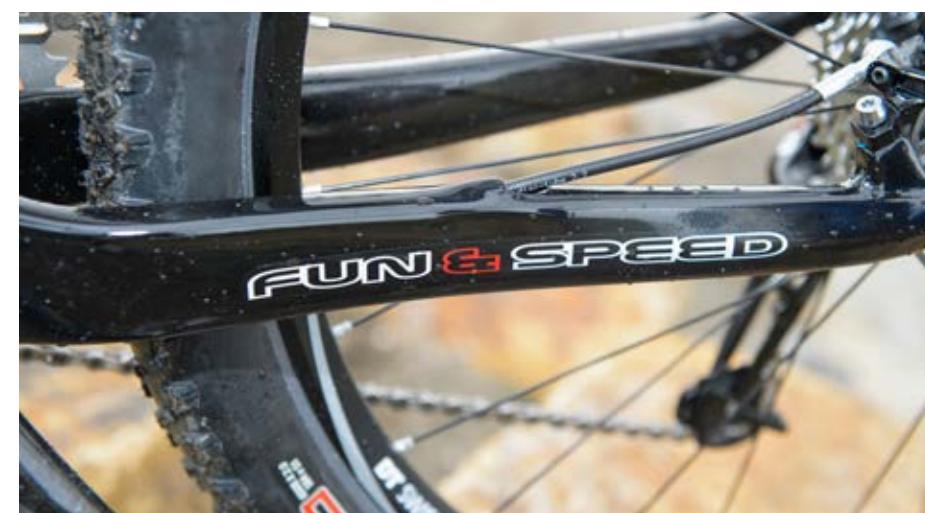
Achterremleiding door het frame
